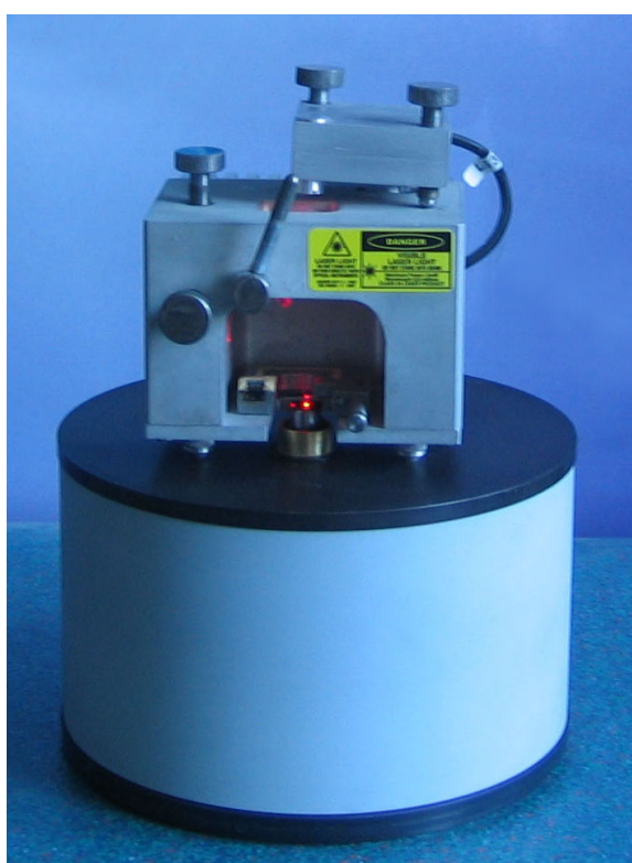
Рис. 1.3. Механическая система микроскопа ФемтоСкан.
