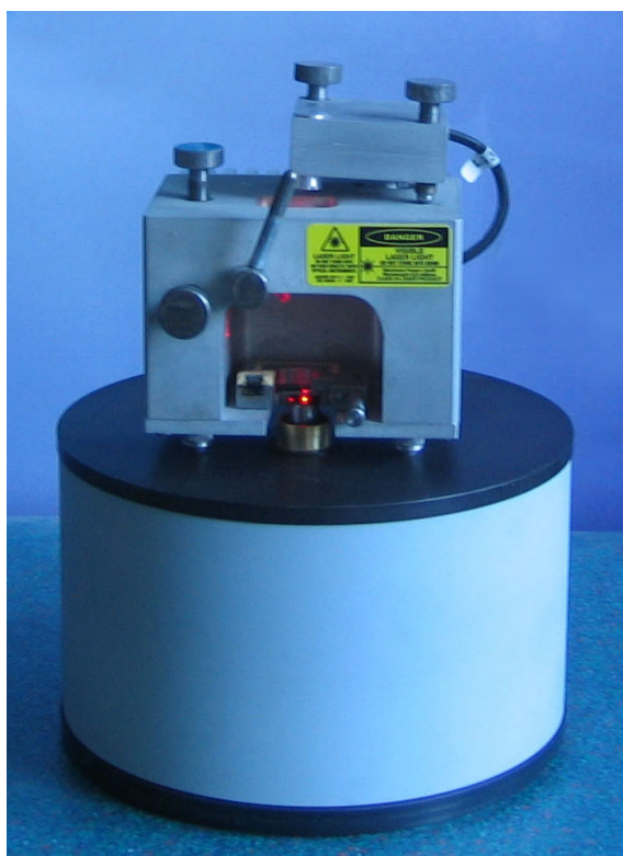
Рис. 1.7. Механическая система микроскопа FemtoScan.
